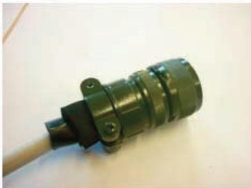
*ENVELOPPER LE CABLE DANS UNE GAINE AFIN D'EN AUGMENTER L'ÉPAISSEUR ET D'OBTE-
