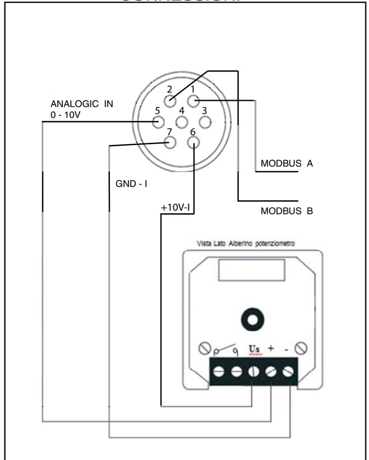
NOTE: Il faut que les câbles A et B pour la connexion en Modbus pour des opérations d'entretien et de diagnostic atteignent un tableau à hauteur d'homme
