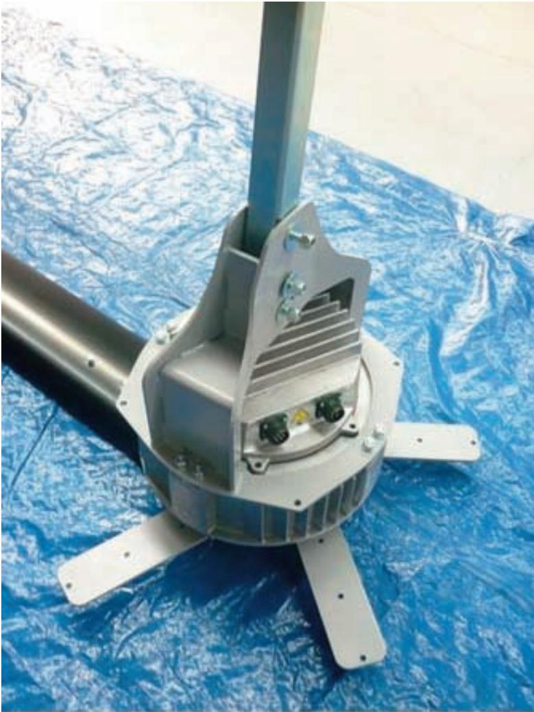
*INSERER LA TIGE DANS L'ETRIER DE SUPPORT DU MOTEUR
