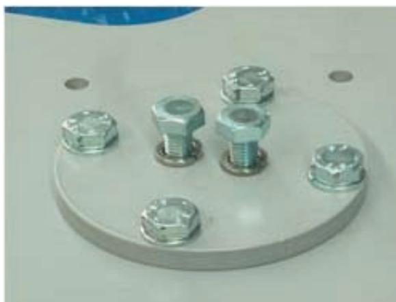
*POSITIONNER LE GROUPE ETOILE-MOYEU SUR L'ARBRE MOTEUR ET SERRER
